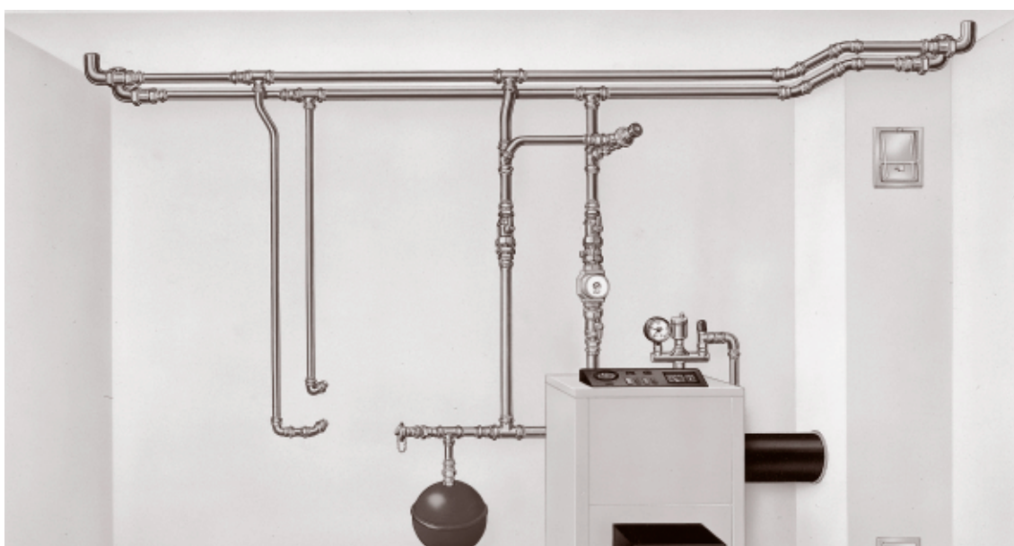
Värmeinstallation utförd med formpressade delar.
